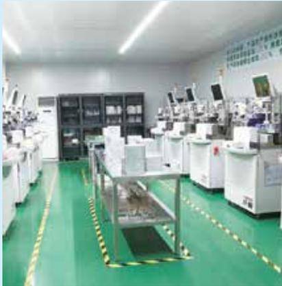
Le macchine di ultima generazione riescono a saldare ciascuna 80.000.000 pezzi al mese. Per la saldatura dei chip LED viene utilizzata una lega contenente oro con una purezza maggiore del 99,99%
