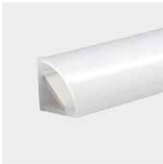
Profilo lineare ANGOLARE IP65 a VISTA in PVC. Diffusore realizzato in policarbonato satinato, rimovibile, resistente ai raggi UV. Il profilo in Alluminio è contenuto all'interno per una corretta dissipazione. Le chiusure stagne (tappi) gli forniscono il grado di protezione IP65. Lunghezza cm 200.
