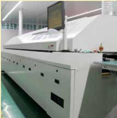
Dopo il posizionamento automatico dei chip, la cottura dello stagno avviene in forno a temperatura stabile controllata.
