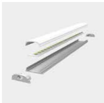
Profilo lineare FLESSIBILE a VISTA in Alluminio anodizzato. Diffusore realizzato in policarbonato satinato, rimovibile, resistente ai raggi UV. Il profilo in Alluminio permette una corretta dissipazione del calore nell'utilizzo di strisce LED. Lunghezza cm 200.
