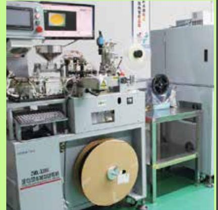
Il selezionatore incanala i chip LED già classificati in modo da ottenere bobine con **BIN IDENTICO**.
