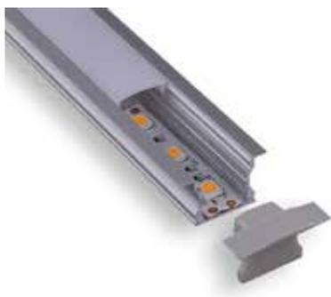
Profilo lineare ad INCASSO. Alluminio anodizzato. Diffusore realizzato in policarbonato satinato, rimovibile, resistente ai raggi UV. Indispensabile per una corretta dissipazione del calore nell'utilizzo di strisce LED. Lunghezza cm 200.
