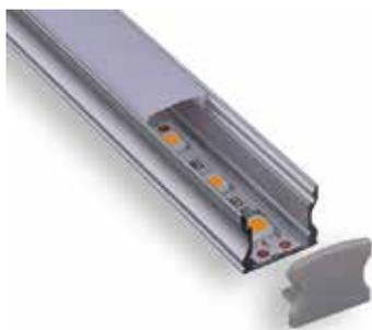
Profilo lineare a VISTA. Alluminio anodizzato. Diffusore realizzato in policarbonato satinato, rimovibile, resistente ai raggi UV. Il profilo in Alluminio permette una corretta dissipazione del calore nell'utilizzo di strisce LED. Lunghezza cm 200.
