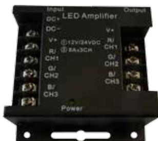
Alimentatore di linea RGB a tensione costante per estendere la potenza di uscita dei controller RGB o più linee di strisce LED.
