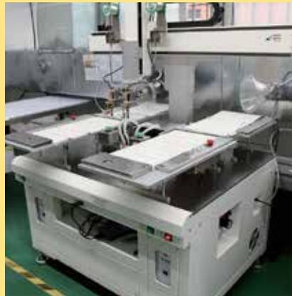
La saldatura dei PCB è effettuata dalla macchina invece che a mano, con un netto miglioramento sui contatti.
