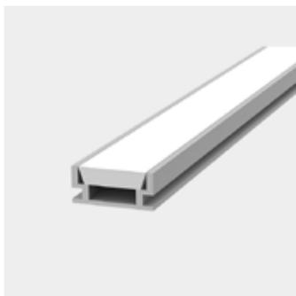
Profilo lineare ad **INCASSO CALPESTABILE**. Alluminio anodizzato. Diffusore realizzato in policarbonato satinato, rimovibile, resistente ai raggi UV. Indispensabile per una corretta dissipazione del calore nell'utilizzo di strisce LED. Lunghezza cm 200.
