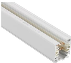
Binario elettrificato 3 accensioni, in alluminio estruso verniciato bianco. Sezione rettangolare con profilo asimmetrico per la corretta connessione dei fari, secondo lo standard. Quattro conduttori in rame isolati in PVC per tre fasi ed un neutro (max 16A- 220/240V).
