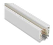
Binario elettrificato 3 accensioni, in alluminio estruso verniciato bianco. Sezione rettangolare con profilo asimmetrico per la corretta connessione dei fari, secondo lo standard. Quattro conduttori in rame isolati in PVC per tre fasi ed un neutro (max 16A- 220/240V).
